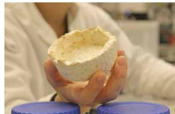
Dieser erste Prototyp sieht noch etwas grob aus. Doch die Grundform einer Schale ist klar erkennbar – und besteht aus Myzel.
