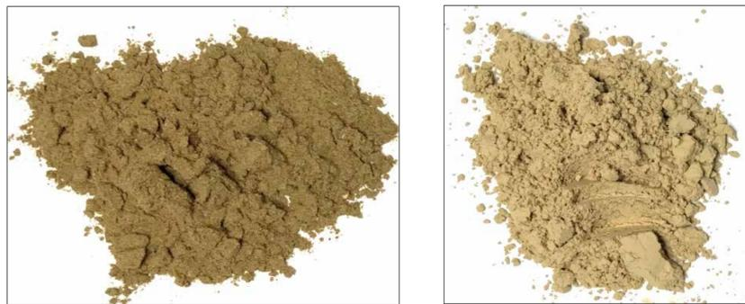
Abb. 3: Grobfraktion (links) und Feinfraktion (rechts) nach 2-facher Sichtung
