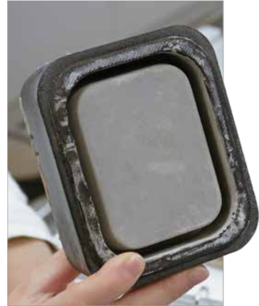
Diese Form aus dem 3D-Drucker besteht aus zwei Teilen. Eine Außen- und eine Innenform sorgen für eine besonders dünne Wand der Schale, die aus Myzel erwachsen soll.
