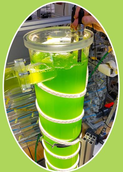
Mikroalgen werden für die Forschung in einem Photo-bioreaktor kultiviert.
