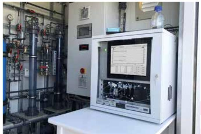
ANTHROPLAS – erstes vollautomatisches Analysensystem zur Messung von anthropogenen Mikroschadstoffen im Abwasser (© ECH)
